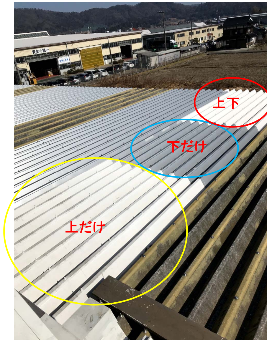
底への結露(霧による水滴の付着を含む)試験実施環境 ガイナ塗装位置
