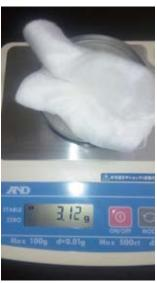
60分後脱脂綿で表面結露を拭き取り、質量を測定 ガイナ鉄板 2.57g(試験前2.45g) +0.12g 通常鉄板 3.12g(試験前2.46g) +0.66g 1 mあたりに換算
