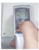
室温19℃ 相対湿度72% 通常鉄板 -12℃ ガイナ鉄板 -7℃ 庫内温度-15℃の冷凍庫から出し た直後で既にガイナ鉄板の方が表面 温度は高い。
