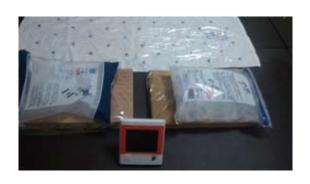
鉄板の温度を低温に保つために鉄板の下には 等量のロックアイスを敷き、ロックアイス表 面で発生する結露の影響を排除するためにタ オルとクッキング用ラップを敷いた上に試験 体を乗せて測定した。
