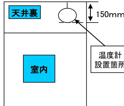
施設天井裏(屋根下150mmの箇所)に温度計を設置。天井裏の温度を測定する。
